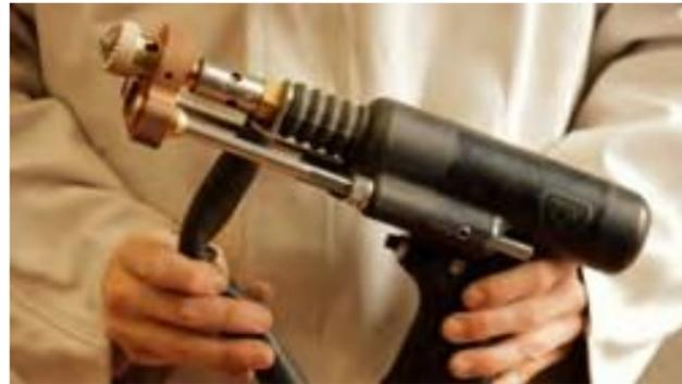
Componentes exteriores de la pistola de soldadura de Studs (TUFFSTUDDS®)
