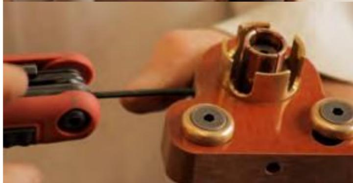
4) Alinee los orificios y coloque los tornillos.
