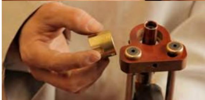
3) Coloque la pinza del ferrule en la pieza de pie alineando los orificios y ajuste los tornillos.
